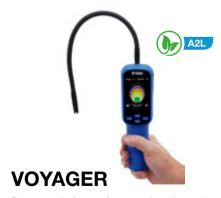
Detector de fugas de pentodo calentado válido para refrigerantes halogenados, A2L y SF6.
